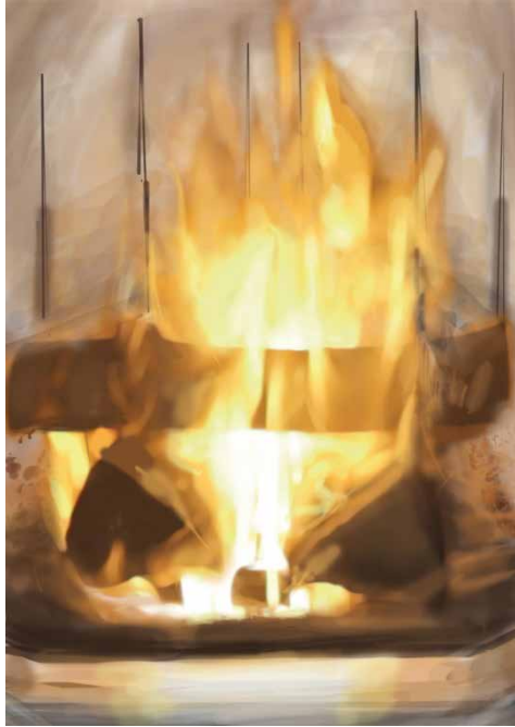
Der Moment des Drosselns ist gekommen, sobald die Flammen die gesamte Holzmenge erreicht haben.
