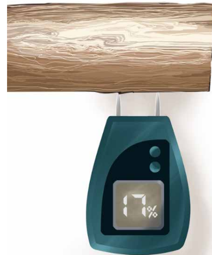
Zwei Elektroden werden in das Holz eingeschlagen. Der Widerstand beim Stromfluss ist für den Restwassergehalt bezeichnend.
